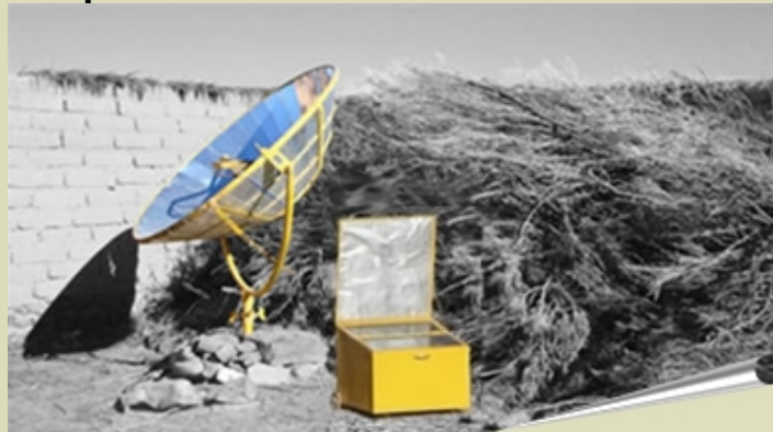
Cocina y horno solar utilizados en la Región de la Puna; detrás, leña de tola.
